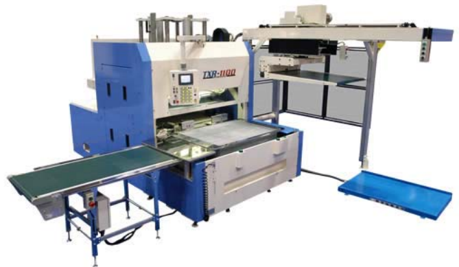
Powyżej: TXR 1100 Blank Separator do obróbki papieru w rozmiarze B1 z ładowarką papieru, podnośnikiem palet i przenośnikiem taśmowym
