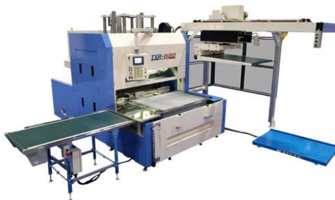
Ci-dessus: Séparateur de poses TXR-1100 — format maxi 1020x720mm, avec margeur papier
